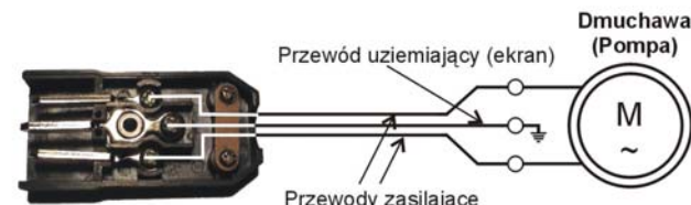
Rys. Podłączenie przewodów od dmuchawy/pompy do wtyczki
